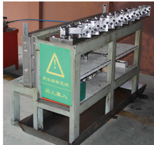
燃油喷射体压力实验工装
